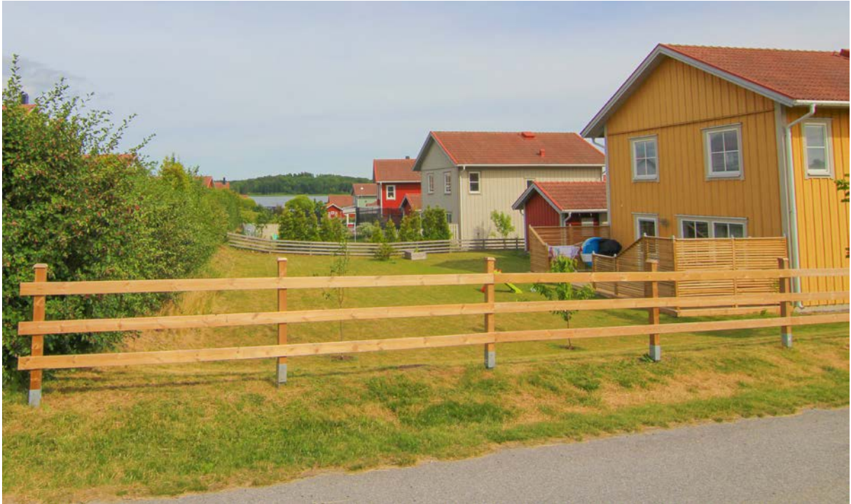
På exemplet är det ca 15 meter mellan häcken och byggnaderna. Genomsiktligt staket tillsammans med en viss lutning bidrar till att sikten genom området är god. (Foto från Näckrogränd i Gnesta)
